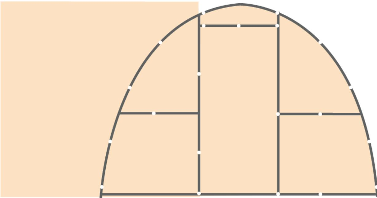
4.1.4. Paigaldage hinged uksele ja õhuaknale puurotsaga kruvide abil. Kõik hinged peavad paiknema polükarbonaadist väljaspool. Kinnitage pöörid puurotsaga kruvidega õhuaknale ja uksele. Seejärel, vastavalt puuritud avaustele, kinnitage uks.
